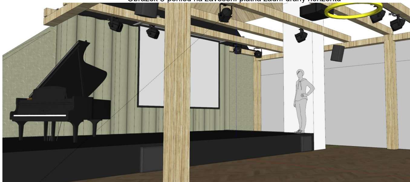
Obrázek 3-pohled na zavěšení plátna zadní dráhy horizontu
